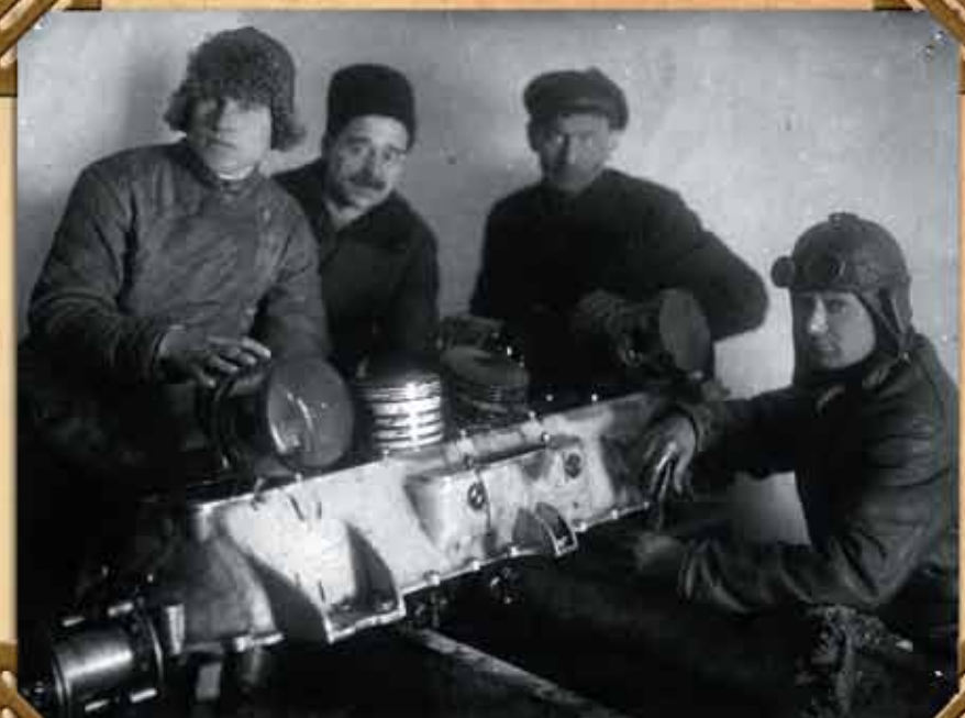
Механик самолета Юнкерс «Все в Авиахим» Клочко вместе с местными мастерами за переборкой авиадвигателя. Пермь, 1925 год.
